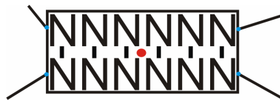
Obrázok 3.3: Príklad štruktúry vrcholu elementu hélix alebo relácia. Modré body označujú asociačné body vrcholu a červený bod označuje jeho ťažisko.
